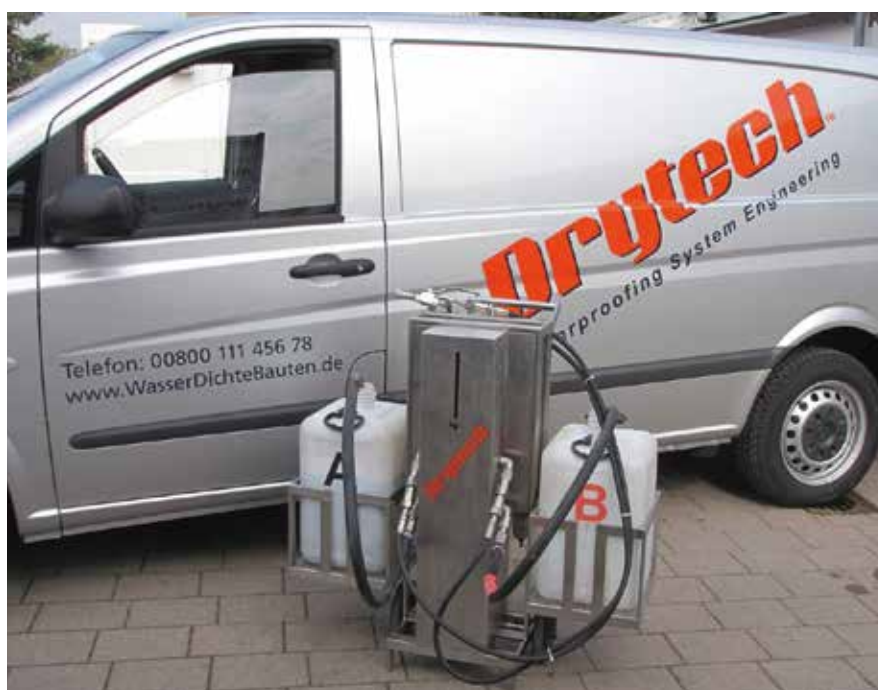
Die Injektion des Abdichtungszarzes DRYflex erfolgt nach der Aushärtung des Betons über eine Zwei-Komponenten-Injektionsanlage.
