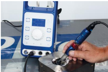
Schnellspannhandstück mit der Steuereinheit ENESKAmicro im Hintergrund beim Polieren mit Diamantpasten und Polierruch. | Bildnachweis: joke Technology GmbH
