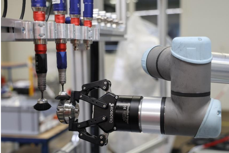
Automatisierte Oberflächenbearbeitung in der Serienfertigung mit ENESKArobotics von joke Technology. | Bildnachweis: joke Technology GmbH
