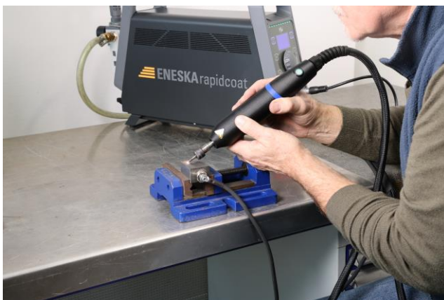
Neuentwicklung von joke Technology: Hartmetallbeschichten mit ENESKArapidcoat. | Bildnachweis: joke Technology GmbH
