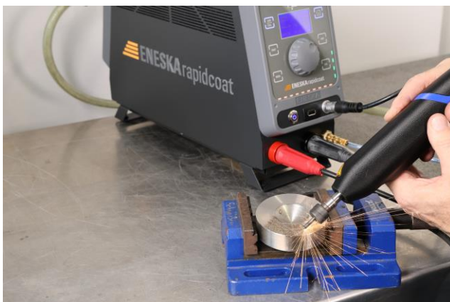
ENESKArapidcoat: gleichmäßige Beschichtung größerer Metalloberflächen in kurzer Zeit. | Bildnachweis: joke Technology GmbH
